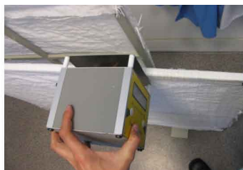
Rys. 11b. Pomiar czasu zaniku ładunku z CPM poprzez badany obiekt (instalację, urządzenie)
