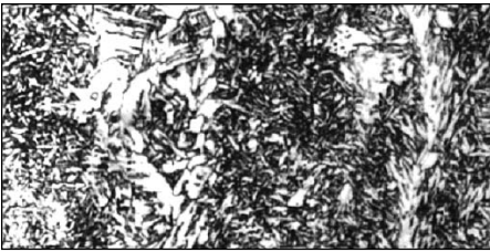
Rys. 11. Struktura stopiwa zasadowych elektrod o zawartości 2% Ni, ponad 70% drobnoziarnistego ferrytu (AF), powiększenie \times 200 , trawiono Nitalem.
