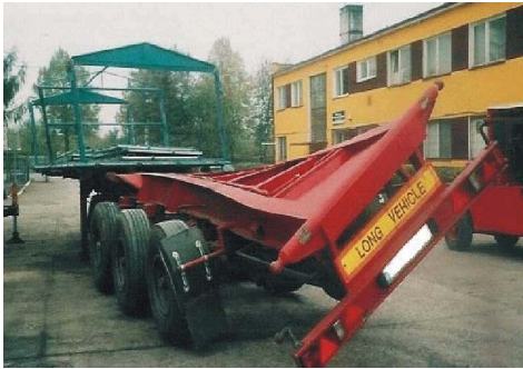
Rys. 1. Odkształcenie ramy naczepy samochodowej [13]
