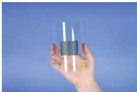
Rys. 4. Folia PET z nałożoną pastą CNT-Ag [9]. Fig. 4. PET film with CNT-Ag paste.
