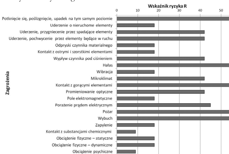
Rysunek 3. Wartości wskaźnika ryzyka R dla zagrożeń zidentyfikowanych podczas natryskiwania cieplnego z chłodzeniem mikrostrumieniowym
